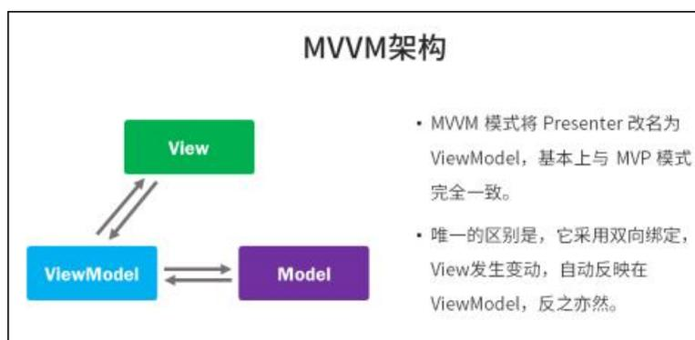
View 就是 DOM 层，ViewModel 就是通过 `new Vue()` 的实例对象，Model 是原生 js。开发者修改了 DOM，ViewModel 对修改的行为进行监听，监听到了后去更改 Model 层的数据，然后再通过 ViewModel 去改变 View，从而达到自动同步。
